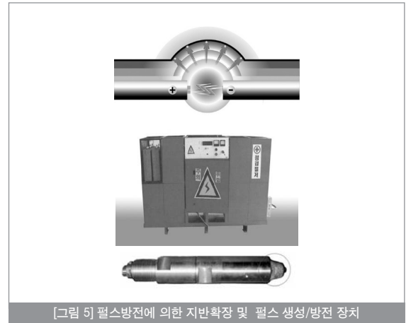
[그림 5] 펄스방전에 의한 지반확장 및 펄스 생성/방전 장치
