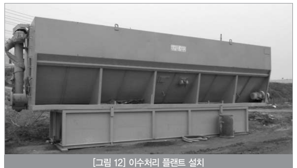
[그림 12] 이수처리 플랜트 설치
