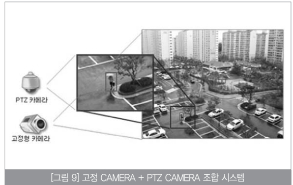
[그림 9] 고정 CAMERA + PTZ CAMERA 조합 시스템
